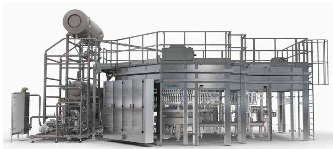
Modulfill VFS-M 中的“M”即代表混合机 (Mixer)，因为其直接连在灌装机上。产品提升后的碳化容器直接进入分配器，无需使用传统的灌装机环缸。由于优化了接口，组件的数量也得以减少，这样不仅减少了占地面积，还降低了运营成本。
