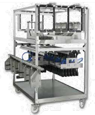
Garniturenwagen zur sicheren Lagerung aller manuell wechselbaren Garniturenteile
