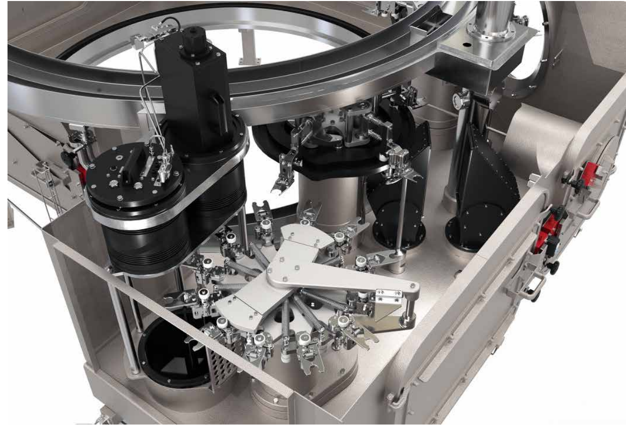
Inspección de la superficie de estanqueidad en el Contipure AseptBloc
