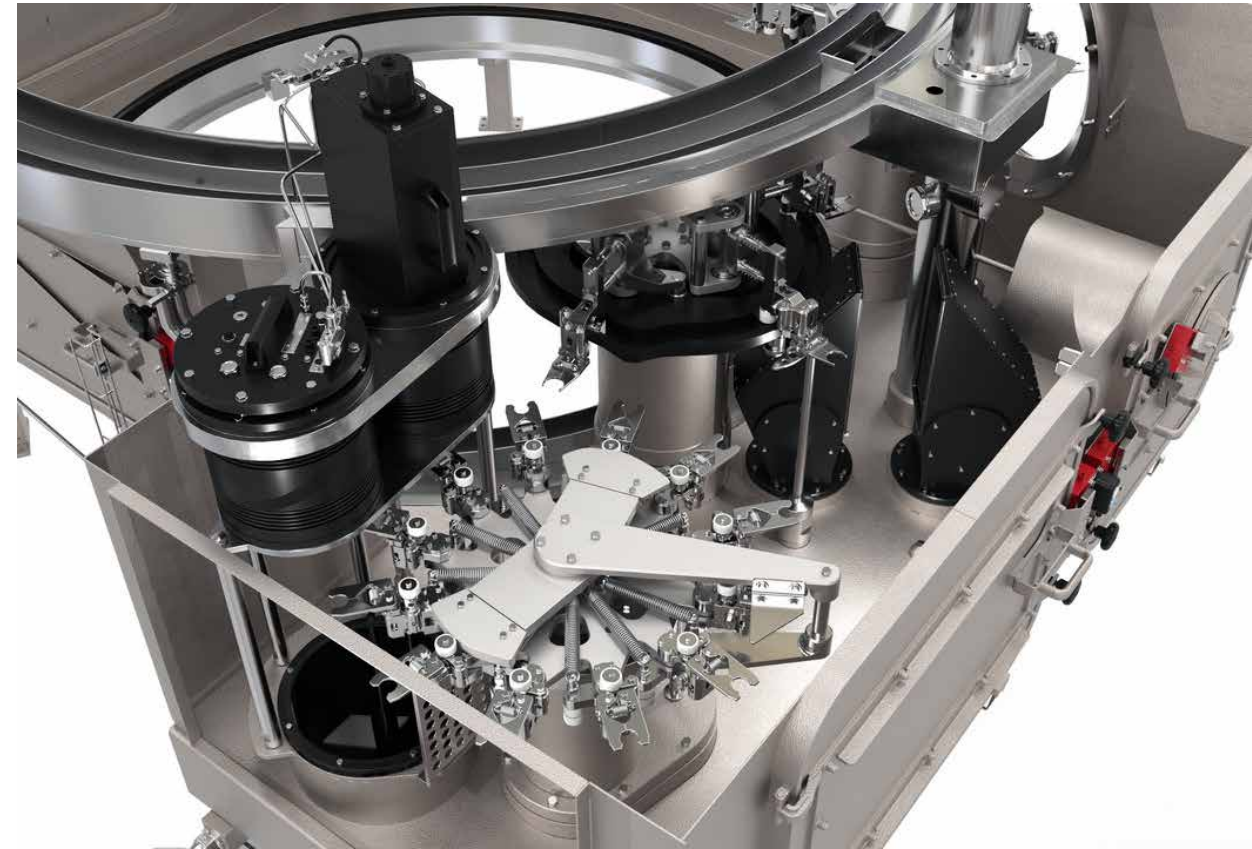
Dichtflächen-Inspektion im Contipure AseptBloc
