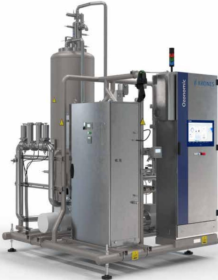
El sistema Ozomatic trabaja según el principio de la "descarga de barrera dieléctrica". Para ello el oxígeno fluye a través del módulo del generador de ozono. Los electrodos de alta tensión allí contenidos sueltan energía eléctrica que se encarga de que se disocian las moléculas de oxígeno ( $O_2$ ) y que se formen moléculas de ozono ( $O_3$ ).
