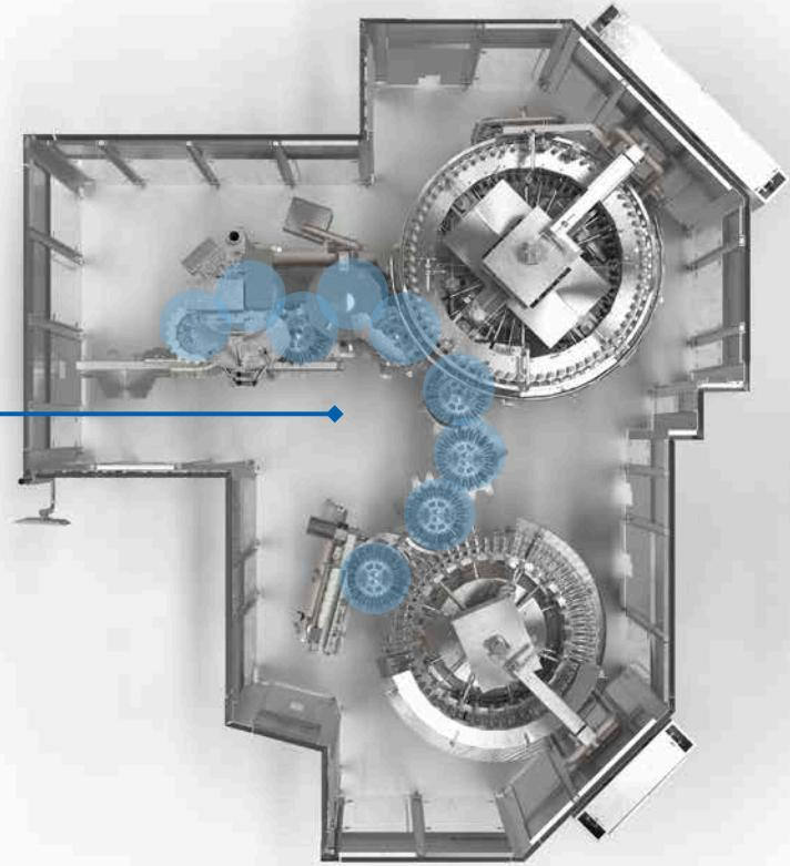
\* Ejemplo de instalación: Enjuagadora Moduljet con diámetro primitivo de 3.600 mm y 90 estaciones de enjuague; Ilenadora Modulfill con diámetro primitivo de 4.320 mm y 108 estaciones de llenado; dos taponadoras
