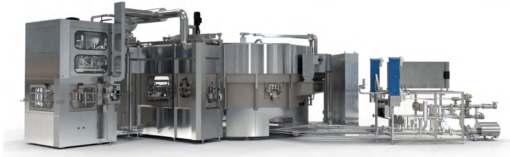
Dosenfüller und -verschleißer Modulfill Bloc FS-c – eine der vielen nachhaltigen Lösungen von Krones
