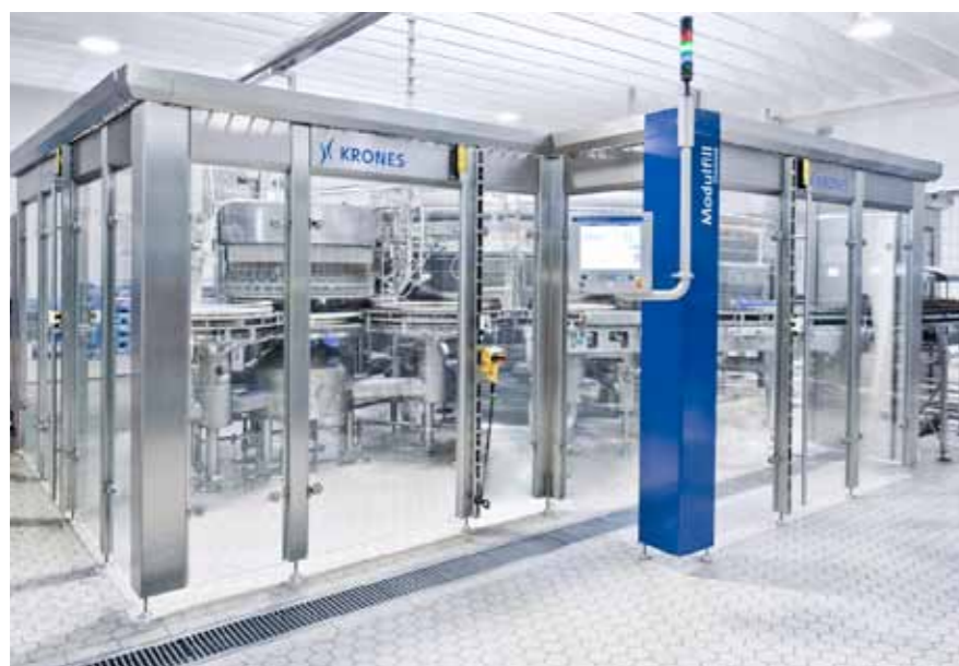
Der modulare Aufbau des Füllers erleichtert die Blockung mit anderen Maschinen.
