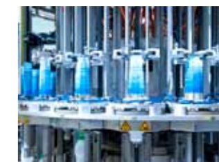
Die neue Etikettiermaschine Sleevematic ES verarbeitet hoch-elastische Folien.
