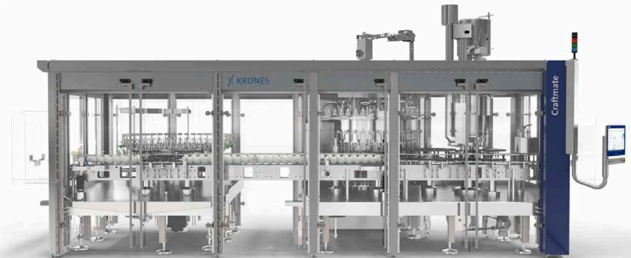
Der Craftmate G als Teil eines Rinser-Füller-Blocks
