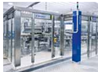
Der modulare Aufbau des Füllers erleichtert die Blockung mit anderen Maschinen.
