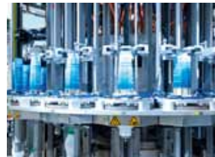
Die neue Etikettiermaschine Sleeveomatic ES verarbeitet hoch-elastische Folien.
